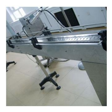
轻型链板输送线具有非常灵活的输送形式,它能够充分有效地利用空间,既可设计成各种机型单独使用, 又能非常方便地和其他输送设备配套。轻型链板输送机主要特点:结构轻巧、运行平稳、噪音低、维护方便。 链板生产线又名链式输送机、链板线输送线等,采用链板拖牵工件做平面传送运动,来达到生产工艺目的。流 水线用组合式装配模式,工位数可按工艺要求设定。工位配置有电源插座、工具箱、料盒等,使整个流程达到 快1速、有序,一般叫链板机或者板链机驱动。输送机中废铁重型链板输送线是常见的输送机类型。无锡输送链 板带
