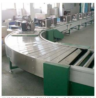
链板生产线又名链式输送机、链板线输送线等,采用链板拖牵工件做平面传送运动,来达到生产工艺目的。流水线用组合式装配模式,工位数可按工艺要求设定。在现代工业装置中,一般采用工业链板输送机为主要生产物料的自动输送设备。通过工业链板输送机,企业可以将生产物料运送到任何地点任何生产工序的加工现场,实现高速的物料配给,加快企业生产节奏,提高企业生产效率。工业链板输送机设备质量的主要指标是其运行速度和承载能力。无锡输送链板带输送链条可用做装配生产线或作为物料的储存输送。
