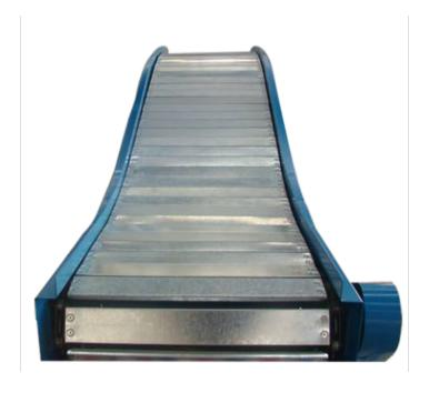
链板生产线调试中的具体注意事项:1. 链板生产线设备的所有系统经彻底检查确认无误后,设备的祖先进行了空载调试工作. 所有故障排除后,再进行10~20小时空载磨合试验,后进行车辆负载试验。2. 链板生产线自动链轮、尾轮和牵引链的轮齿是否在正常啮合条件下工作。如果相差很大,可以通过拧紧链板生产线自动链轮和从动链轮的轴承座螺栓,稍微调整自动链轮和从动链轮的中线位置。3. 调整链板生产线并拧紧组件,使第二牵引链的初始张力平衡适中. 如果链板生产线初始张力过大,将增加功耗; 太少会影响链轮和牵引链的正常啮合优化,增加链板生产线运行的不稳定性。4. 检查链板生产线各行走滚轮是否转动正常。如有卡轨、打滑等迹象,应立即更换或排除故障。5. 链板生产线运行中,所有活动部件如有卡涩、机械强制摩擦等迹象,应立即排除。
